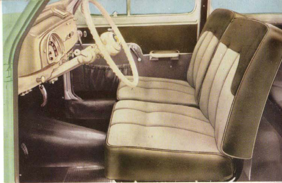
Les sièges avant sont indépendants et peuvent être réglés séparément, selon la taille du conducteur et à la convenance du passager.
