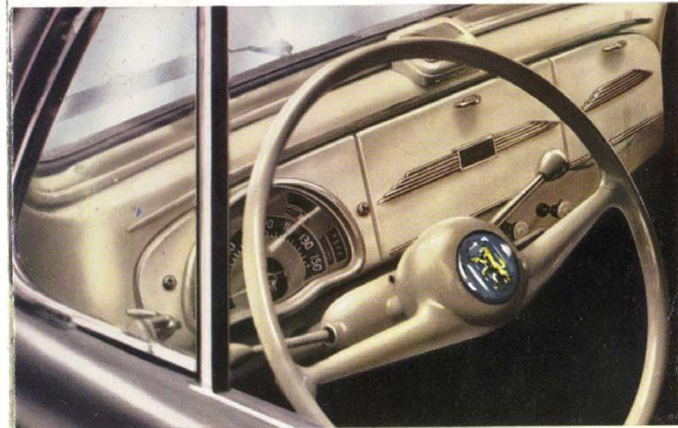
Le tableau de bord groupe, dans l'axe du volant, tous les appareils de contrôle. Des déflecteurs verrouillables équipent les glaces AV.
